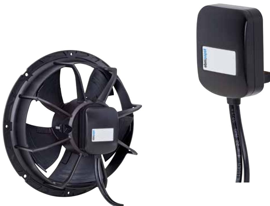
Ce module d'extension élargit la gamme de produits ESM en ajoutant une entrée de commande 0-10V et peut être installé ultérieurement sur les ventilateurs ESM programmables de ce catalogue. Les ventilateurs compatibles sont reconnaissables à l'étiquette « ESM+ enabled ».
