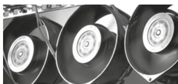
Cabine d'essai chez ebm-papst St. Georgen : 1500 ventilateurs y sont soumis à des tests de résistance à la température jusqu'à défaillance.
