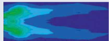
Kälteverteilung ohne Strömungsgleichrichter
