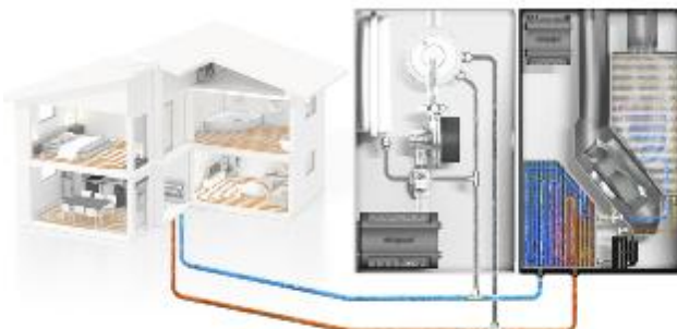
Bild 2: Das übergeordnete Steuerungssystem, die 900H Series Control Platform von ebm-papst regelt Gasbrennwertgerät und Wärmepumpe je nach Situation in ihrer Leistung.
