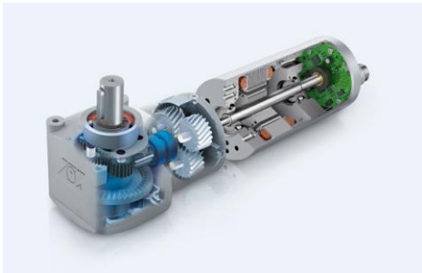
Bild 1: Das evolventische Antriebsritzel beim Kronenradgetriebe baut zylinderförmig und der Kontakt zwischen Ritzel und Abtriebsrad ist ein Wälzkontakt. Es treten kaum Reibungsverluste auf.
